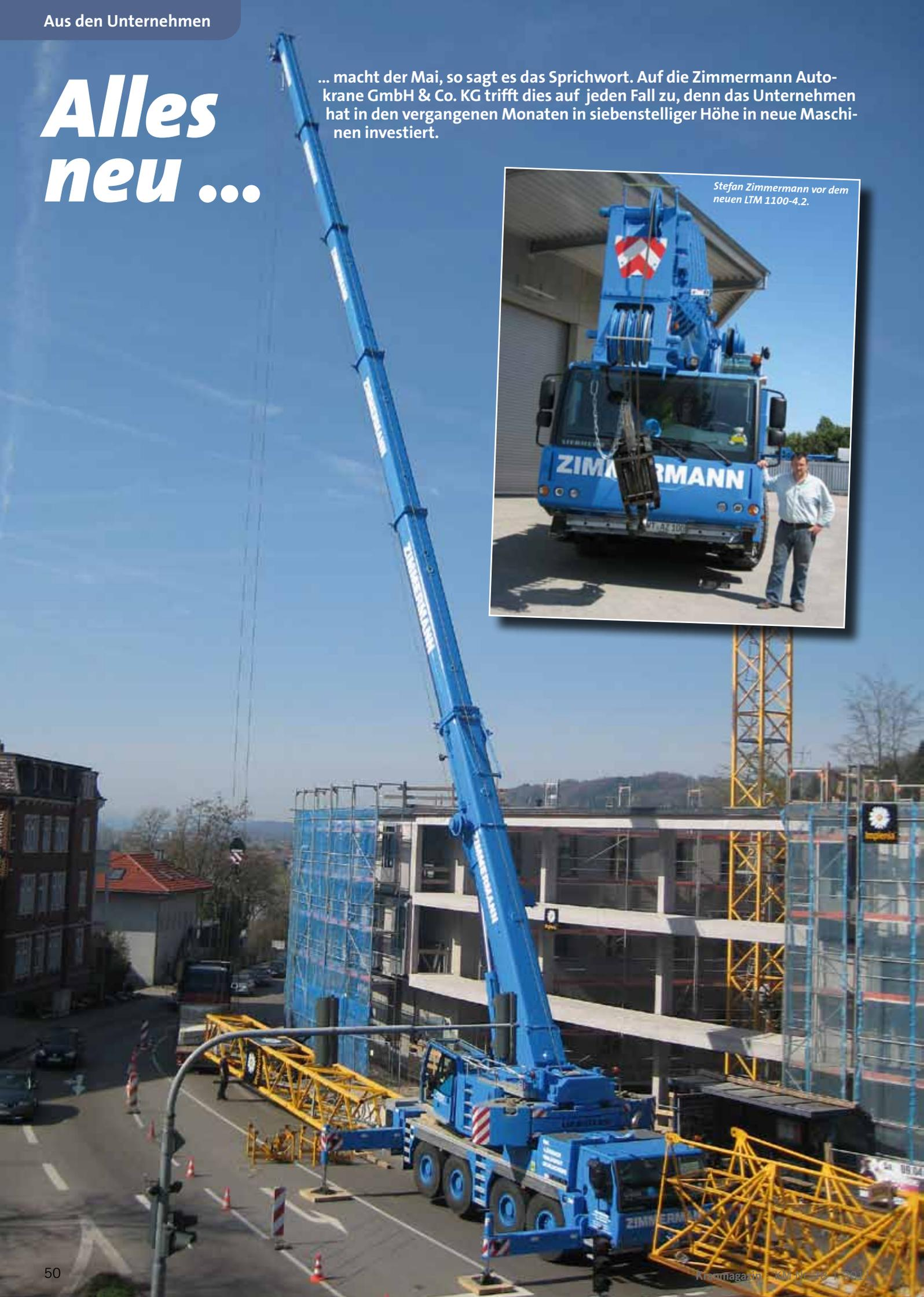
Ein Liebherr LTM 1100-4.2 verstärkt jetzt die Zimmermann-Flotte. Der Kran bietet einen 60 m langen Teleausleger und eine maximale Hubhöhe von 91 m.
